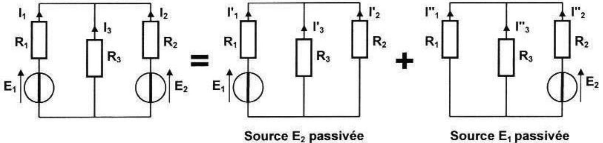
Il faut passiver( éteindre) toutes les sources sauf une et effectuer le calcul de la grandeur : tension aux bornes de la charge ( ou l'intensité dans la branche de la charge) , refaire l'opération jusqu'qu'il ait autant de grandeurs calculées que de sources indépendantes.
