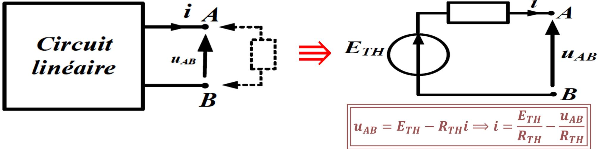
Le but recherché est de remplacer tout réseau électrique (circuit linéaire), qui alimente par les bornes A et B un dipôle D, par un générateur de tension idéal  $E_{TH}$  en série avec une résistance  $R_{TH}$ , c'est ce qu'on appelle le modèle équivalent de Thevenin (M.E.T)
